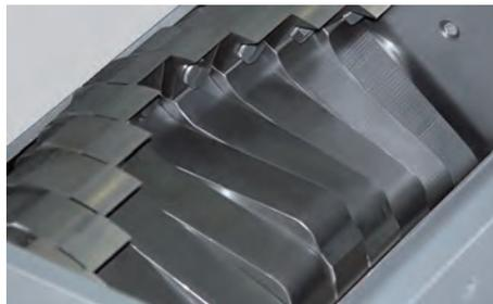
Durch die versetzt angeordneten Rotorsterne sind immer nur einzelne Messer im Einsatz, wodurch eine jeweils höhere Schnittkraft erreicht wird. Sämtliche Maschinen aus der GSL-Baureihe eignen sich somit auch für massivere und dickere Angüsse.
