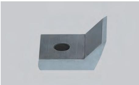
Die speziell geformten Rotormesser gewährleisten auch nach dem Nachschleifen einen gleichbleibenden Schneidkreis, so dass der erforderliche Schnittspalt zwischen Rotor- und Statormessern erhalten bleibt. Somit entfallen jegliche Einstellarbeiten.
