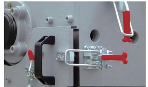
Das ZERMA-Quick-Snap System ermöglicht ein schnelles Abnehmen der geteilten Frontplatte zur einfachen Mühlereinigung ohne den Einsatz von Werkzeugen. Die untere Frontplatte wird über 2 stabile Schnellspanverschlüsse gehalten.
