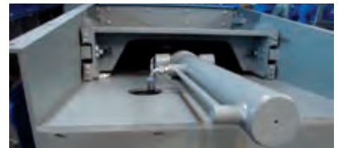
Hydraulikschieber in Schräglage für optimale Zuführung des Materials zum Rotor.
