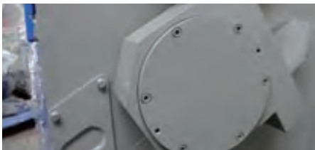
Robuste Steh- bzw. Flanschlager für hohe Lagerstandzeiten.
