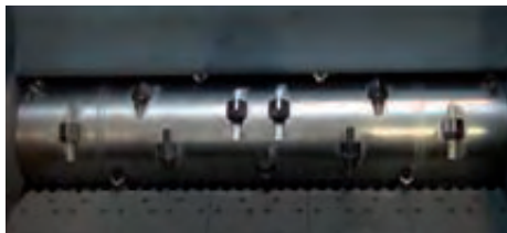
Die Rotoren sind mit konkav geformten Schneidkronen bestückt, die vierfach wendbar sind.
