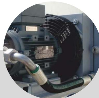
Option: Ölkühlung der Hydraulik, bei Mehrschichtbetrieb notwendig.
