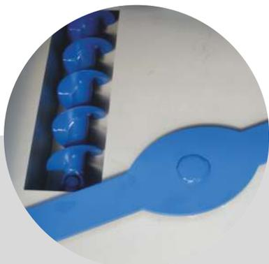
Permanent drehendes Rührwerk mit Ausstragsschnecke zur Förderung in die Presseinheit.
