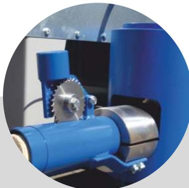
Option: Brikettlängenüberwachung Für die störungsfreie und konstante Produktion von gleichlangen Briketts
