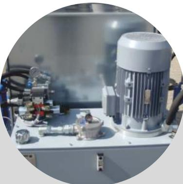
Die Hydraulikeinheit ist separat angeordnet für eine gute Zugänglichkeit bei Wartungsarbeiten.
