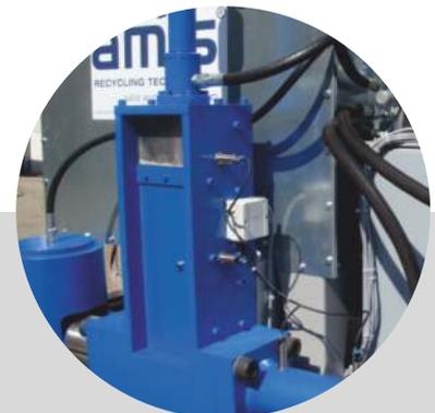
Staubdichter Füllschacht mit Sensoren für einen störungsfreien Betrieb.
